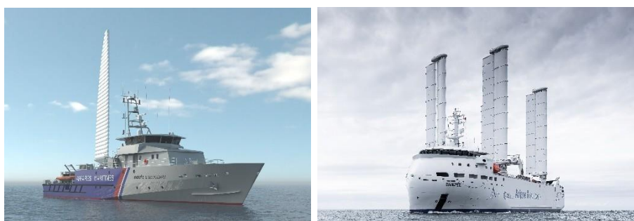
De gauche à droite – Patrouilleur Nouvelle Génération des Affaires Maritimes (PAMNG), Wisamo (nouvelle construction) - @Mauric ; Canopée, Ro-Ro de 121m, 5 400 dwt, OceanWings (nouvelle construction) – @Tom Van Oossanen.
