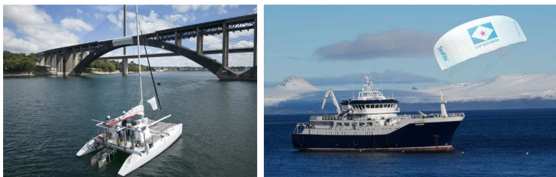
De gauche à droite – Skravik, Prototype de voilier de travail polyvalent, homologué navire de pêche div. 227 de 9,9m (retrofit) ; Cap Bourbon, Navire de pêche de 60m, équipé par Beyond the Sea (retrofit).
