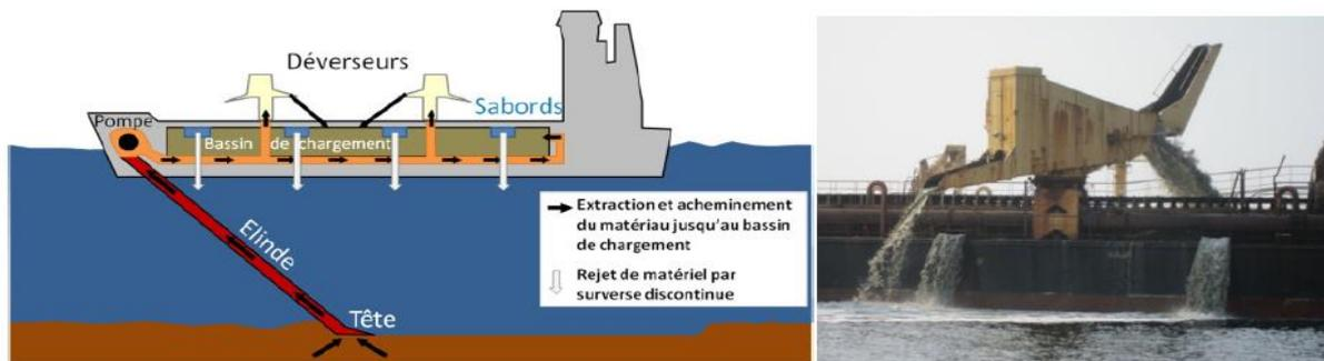
Schéma explicatif du mode d'extraction des granulats par navire extracteur, déversement, et surverse par sabord discontinu (à gauche), et photographie du déversement et de la surverse par sabord discontinu à bord du Sand Heron (à droite)
