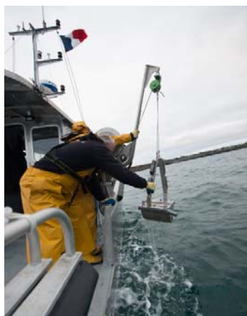
Prélèvement d'échantillons biologiques au moyen d'une benne depuis un navire océanographique, utile pour évaluer l'état écologique des habitats benthiques (source : N. Job)
